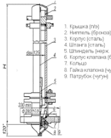
Схема подземного пожарного гидранта
